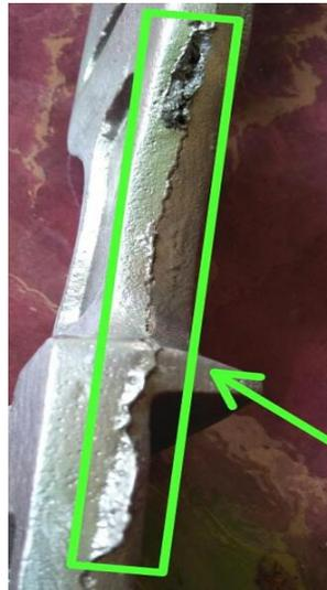
Gambar 4.11 Penambahan sirip pada tepi hasil coran.
