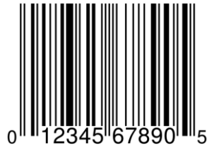
Gambar 2.6 Contoh barcode UPC-A
