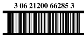
Gambar 2.4 Contoh barcode dengan Bearer Bar
