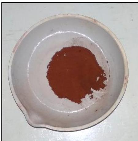
Gambar 3.4 Pigmen *Hematite* dengan Temperatur Kalsinasi  $650^\circ\text{C}$
