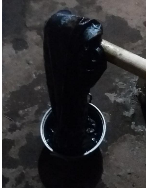
Gambar 3.14 : Nglorod untuk menghilangkan malam pada kain
