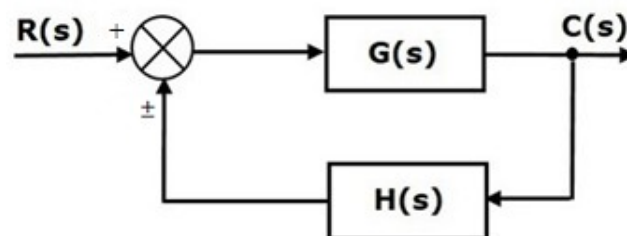
Gambar 2.2. Sistem pengendalian lup tertutup
