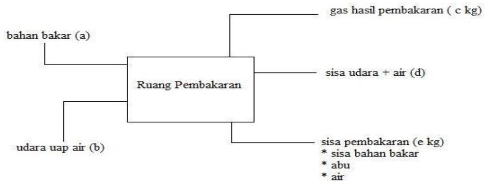
Gambar 2.5 Skema sistem penyaluran bahan bakar menjadi gas buang
