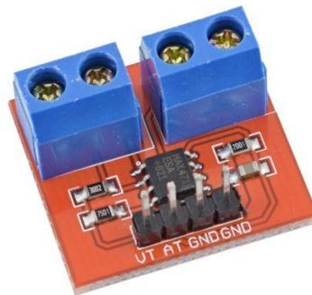
Gambar 2.4 Sensor MAX47 (Voltase dan Arus)
