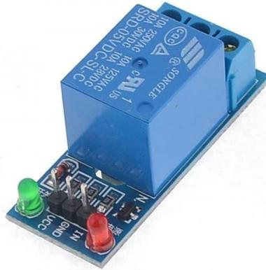
Gambar 2.8 *Relay* pengontrol sumber tegangan
