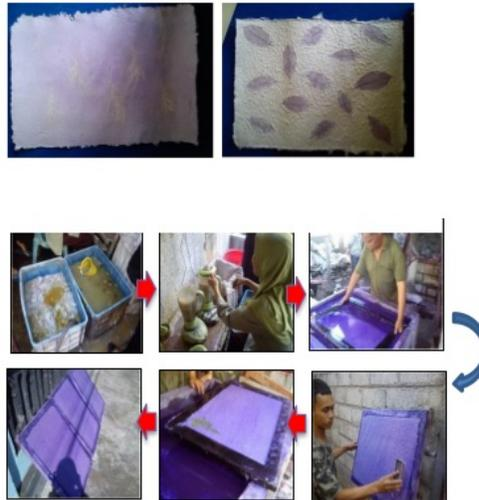
**Gambar2. Proses pembuatan kertas handmade dengan variasi metode cetakan motif**
