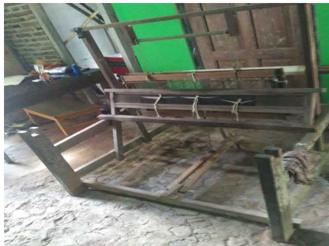
Gambar 2.3 Alat Tenun Bukan Mesin (Dokumentasi Pribadi, 2018)
