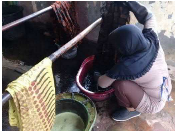
Gambar 2. 15 Proses Pencelupan Mori Yang Sudah Selesai Dibatik (Sumber : Dokumentasi Pribadi, 2017)
