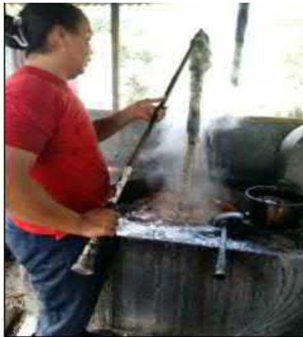
Gambar 2. 18 Proses Nglorod (Sumber : Galih Apriliyanto, 2016)
