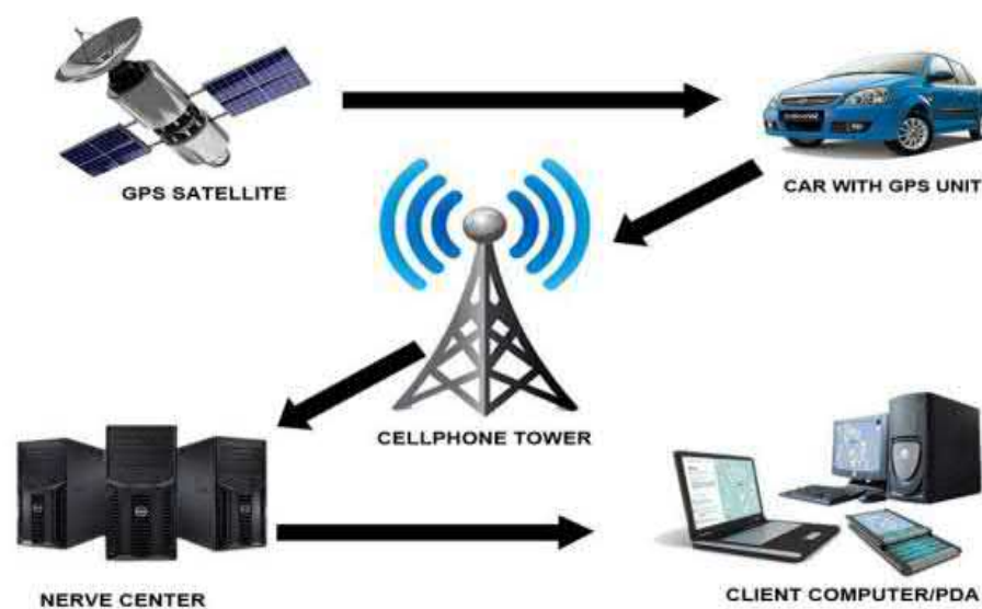
Gambar 2.10 Cara Kerja GPS
