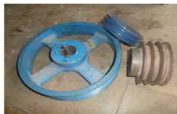
Gambar 13. Beberapa model puli yang terbuat dari bahan cor
