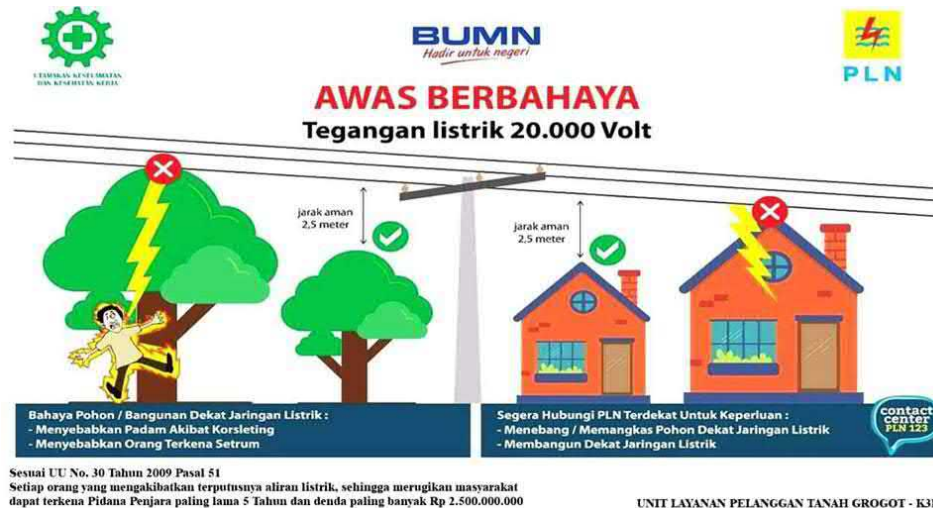
Gambar 2.6 Bahaya pohon atau bangunan di dekat jaringan 20kV
