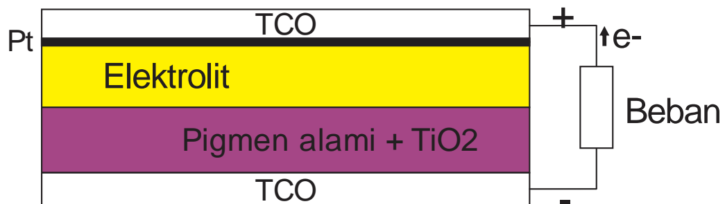
Gambar 2.2 Struktur DSSC berbasis semikonduktor \text{TiO}_2 (Quan, 2006)
