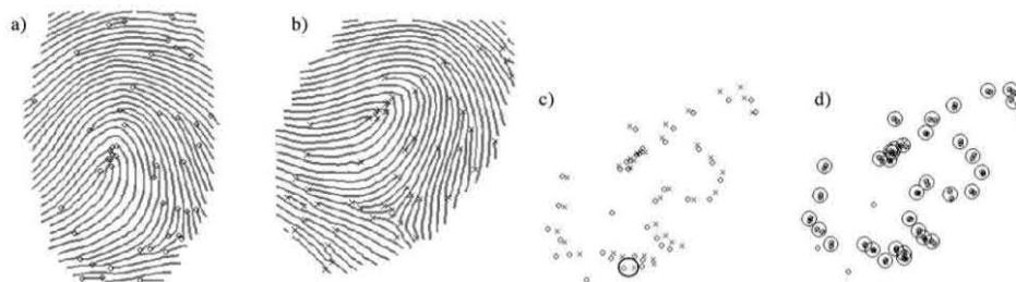
Gambar 9. Proses matching dengan metode minutiae-based methods : a) dan b) minutiae diekstraksi dari template dan input, c) minutiae ditandai dengan lingkaran, d) tiap lingkaran menunjukkan minutiae yang dicocokkan oleh algoritma.
