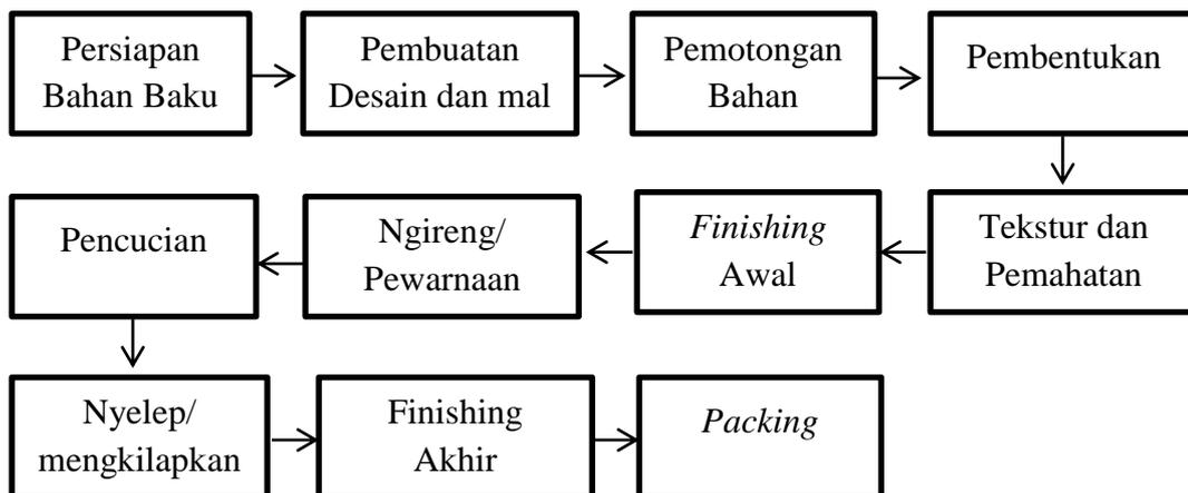
**Gambar 2. 1:** Proses Produksi Industri Logam
