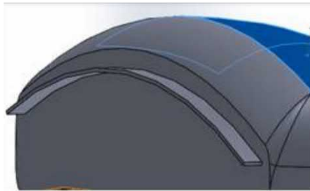
Gambar 2.11 Pemasangan air dam pada bumper depan (Sumber: Damle et al. , 2014)
