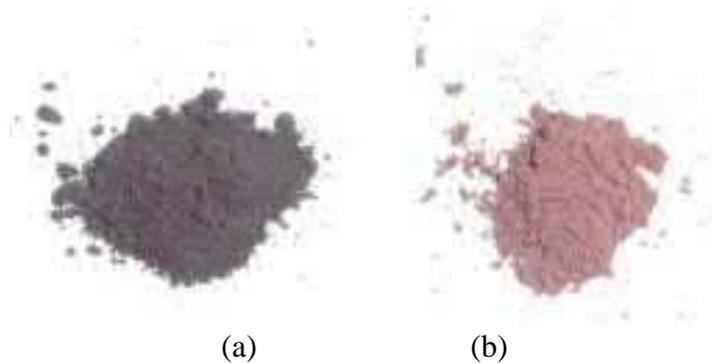
Gambar 2.10 (a) Material magnetit  $\text{Fe}_3\text{O}_4$  dan (b) material hematit  $\text{Fe}_2\text{O}_3$
