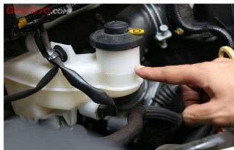
Gambar 2. 12 Pemeriksaan Visual Minyak Rem (gridoto.com)
