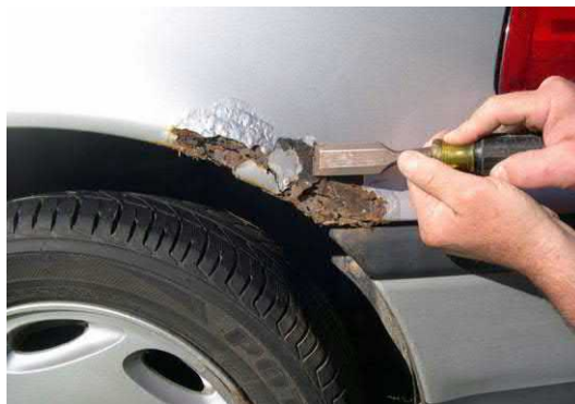
Gambar 2. 11 Korosi Area Spakbor
