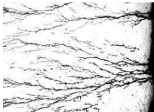
Gambar 2.7 Korosi Tegangan (Utomo, 2009)
