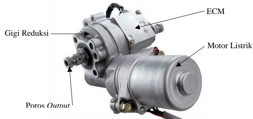
Gambar 2. 5. Motor listrik EPS
