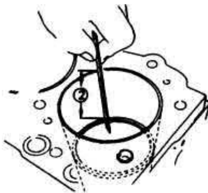
Gambar 2.25 Mengukur Celah Ring Piston Pada Silinder ( Workshop manual engine 4JA1/4JH1 models )
