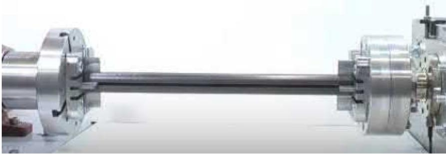
Gambar 8. Benda Uji Pada Pengujian Puntir Dinamis
