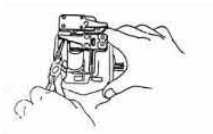
Gambar 2.9. Pemeriksaan dan Pengetesan Regulator (PPGT VE DC, tt:81-82)
