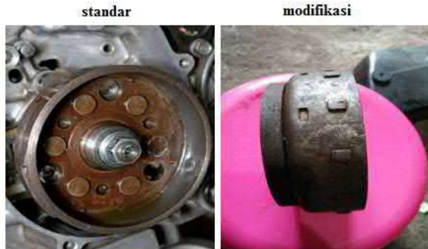
Gambar 2.8 Magnet Honda Karisma 125 sebelum dan setelah dilakukan perubahan tonjolan pickup
