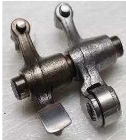
Gambar 2. 9 Visualisasi komponen roller rocker arm
