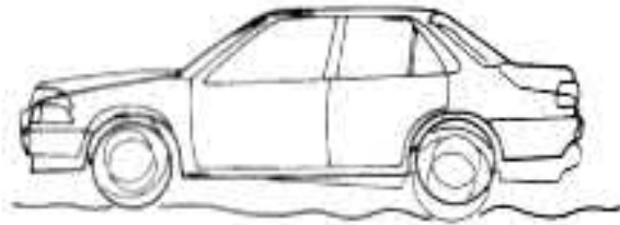
Gambar 2.24 Keadaan kendaraan saat pitching Sumber: (Isuzu 2007)
