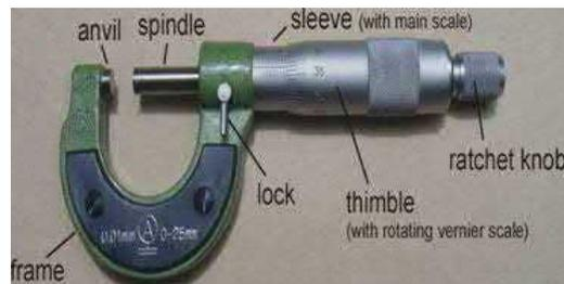
Gambar 2.15 Bagian *micrometer*
