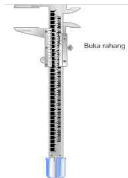
Gambar 2.13 Mengukur kedalaman benda
