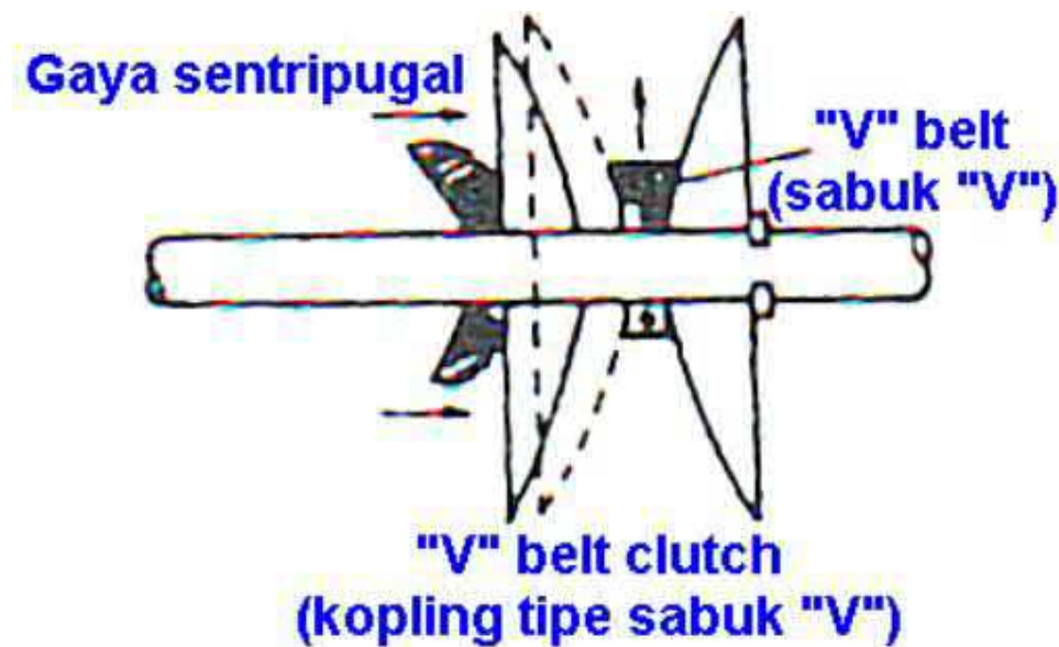
Gambar 2.7. Kopling tipe V belt (Jama dan Wagino, 2008)
