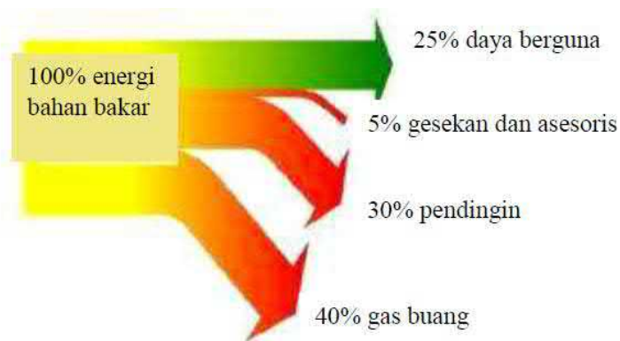
Gambar 2.2 Keseimbangan Energi Pada Motor Bakar. (Raharjo dan Karnowo, 2008:93)
