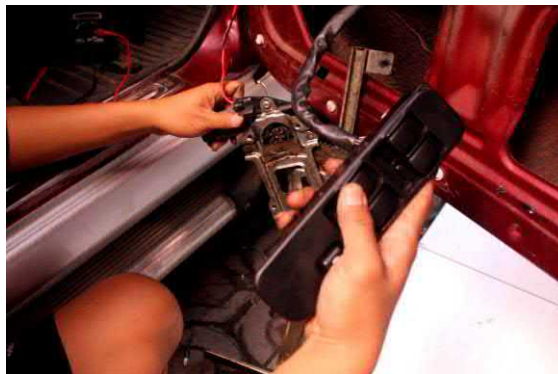
Gambar 2.43. Pengecekan motor power window
