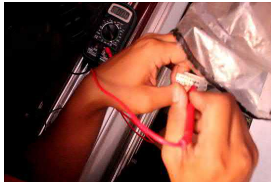
Gambar 2.40. Pengecekan arus pada konektor
