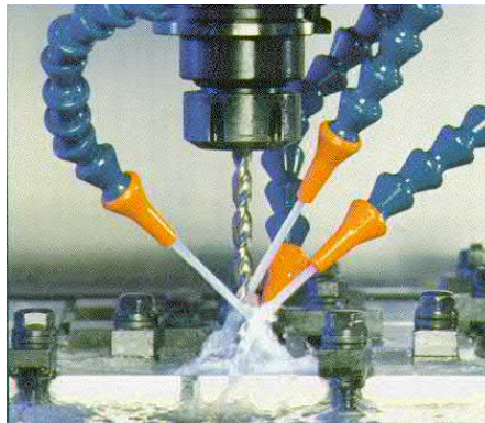
Gambar 2.7 Cara pendinginan dengan cairan pendingin disemprotkan langsung ke daerah pemotongan pada proses pembuatan lubang.
