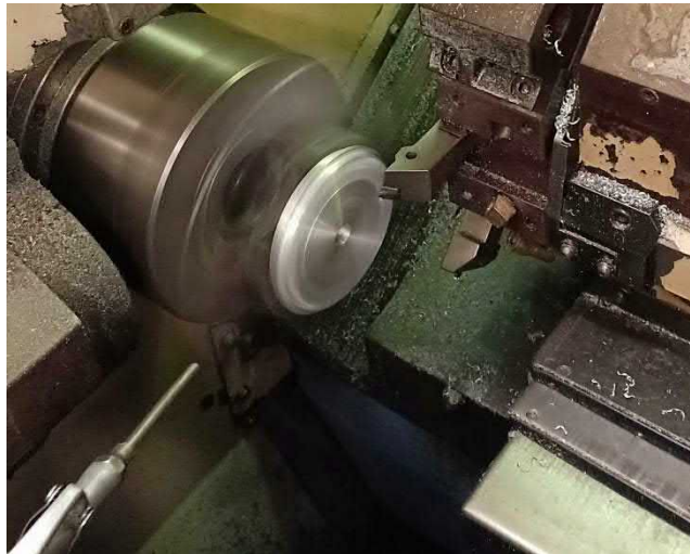
Gambar 2.8 Beram hasil pemotongan tersingkir karena ada aliran media pendingin sehingga memudahkan dalam penanganan/ pembersihannya.
