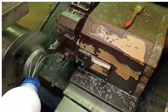
Gambar 2.6 Pemberian cairan pendingin dengan cara menyiramkan pada benda kerja.
