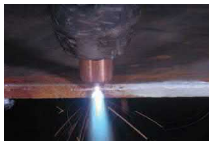
Gambar 2.18 Kerf Sumber: (Jeffus, 2012: 550)
