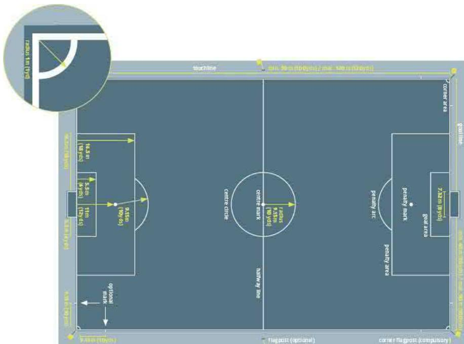
Gambar 2.18. Standar FIFA Ukuran Lapangan Sepak Bola
