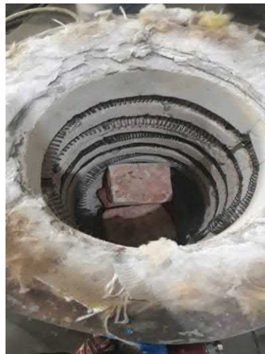
Gambar 2.3 Lining pada Tungku Induksi
