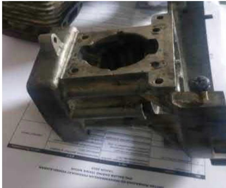
Gambar 2.8 *Crankcase* mesin pemotong rumput
