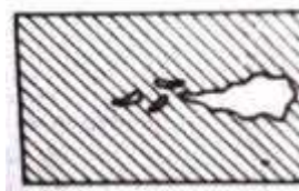
Gambar 2.5. Cacat Rongga Penyusutan (Sumber: Surdia, 1976: 213)
