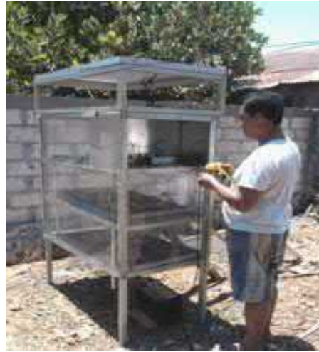
Gambar 2.3 Alat pengering ikan asin ramah lingkungan menggunakan integrasi panel surya dan energi matahari
