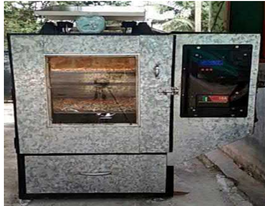
Gambar 2.2 Alat pengering ikan dengan sistem perancangan perangkat pengeringan ikan otomatis berbasis arduino dengan sumber daya mandiri (Sari, 2016)
