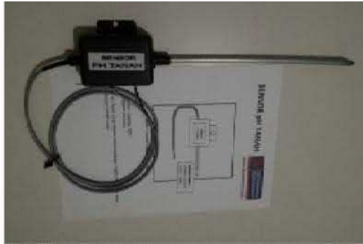
Gambar 2.3 Sensor Ph Tanah
