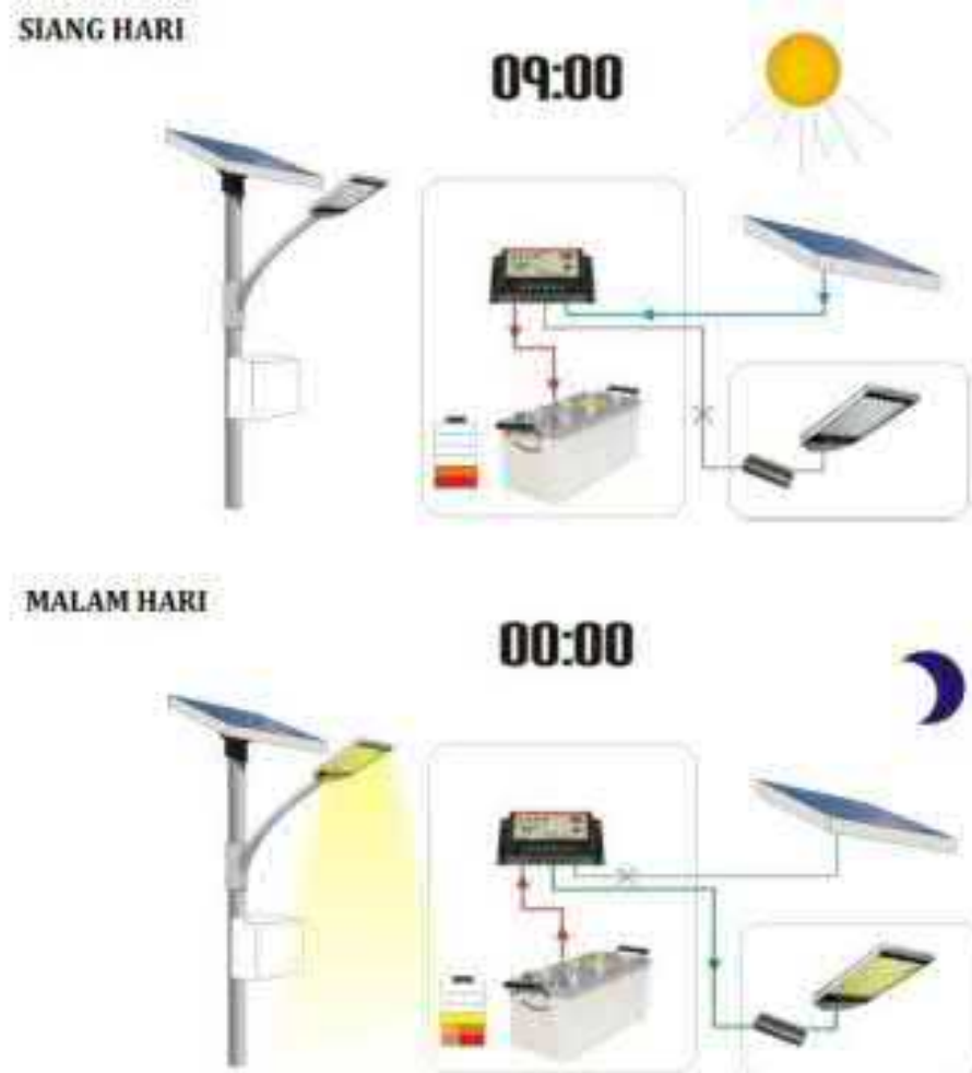
Gambar 2.6. Prinsip Kerja PJU Tenaga Surya Sumber : TMLEnergy
