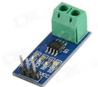
Gambar 2.9 Bentuk fisik sensor arus ACS712 20A
