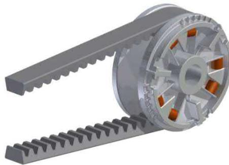
Gambar 2.14 Posisi *Roller* dan *V-belt* Putaran Tinggi
