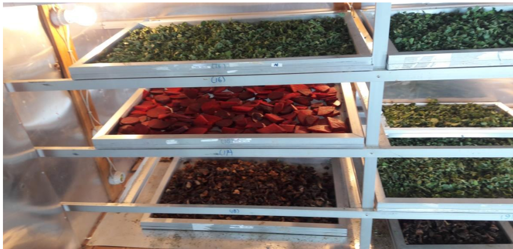
Gambar 4. Pengeringan umbi bit dalam lemari pengering selama 5 hari
