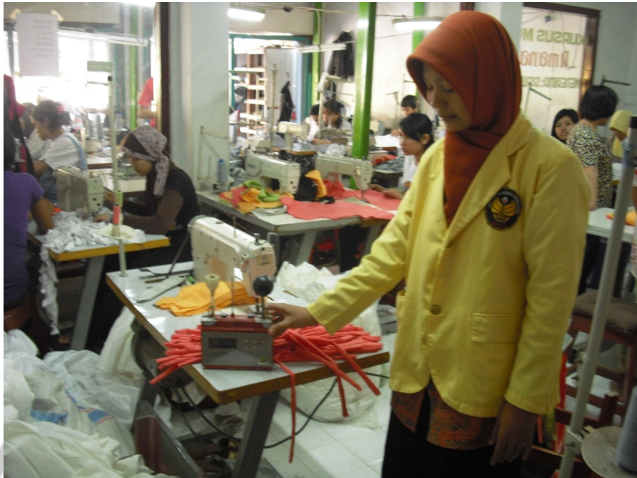
Dokumentasi 5 Pengukuran Tekanan Panas (Iklim Kerja) pada Bagian Penjahitan Konveksi Aneka
