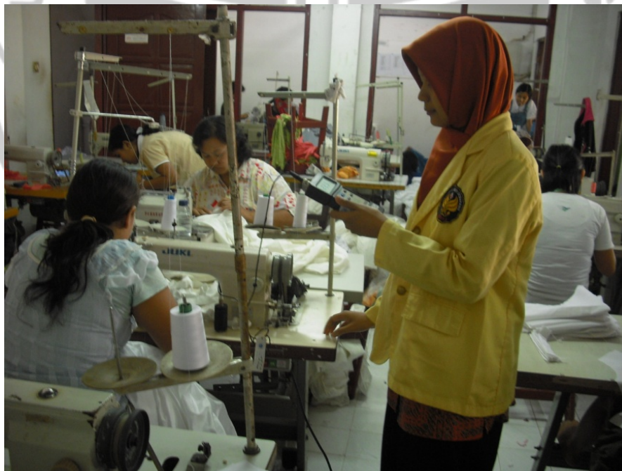
Dokumentasi 6 Pengukuran Getaran Mesin Jahit pada Bagian Penjahitan Konveksi Aneka
