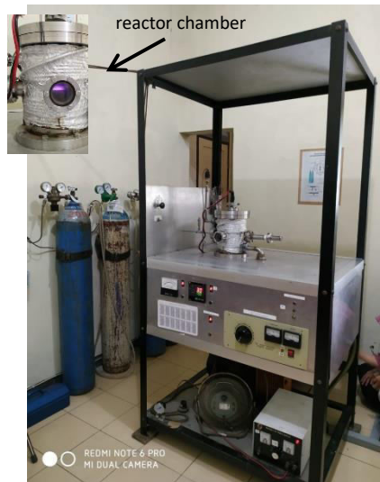
Gambar 10. Reaktor Sputtering yang dirancang bangun (inzet: reactor chamber )
