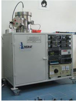
Gambar 7. Reaktor DC PECVD yang dirancang bangun di Advanced Membrane Research Unit (AMRU) , Fakulti Kejuruteraan Kimia dan Sumber Asli (FKKSA), Universiti Teknologi Malaysia.
