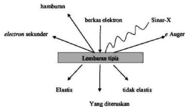
Gambar 5.17: Hamburan dari elektron jatuh pada lembaran tipis (Smallman, 1999: 142)
