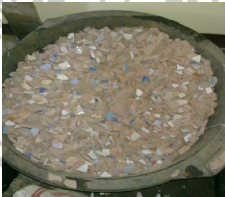
Pecahan Keramik sebagai agregat halus dalam pembuatan bata beton berlubang
