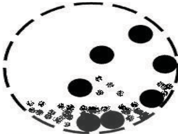
Gambar 2.5 Material dan bola penghancur didalam vial (dinding vial = lingkaran dengan garis putus-putus, bola penghancur = bulat hitam besar, material = bulat hitam kecil).
