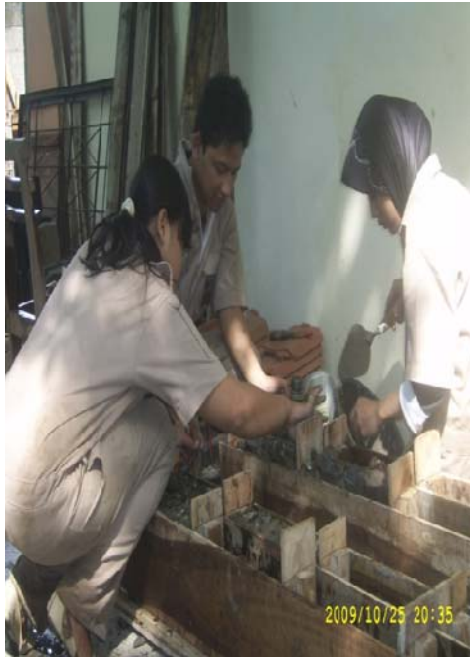
Proses Pengecoran dan Pemasakan
