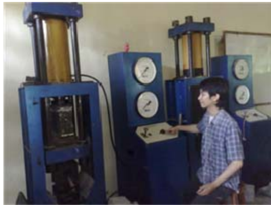
Gambar. 2.2 Pengujian bata beton non-pasir dengan mesin tekan.
