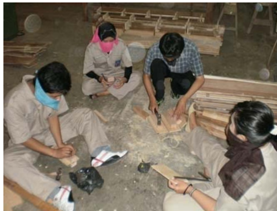
Gambar. 2.5 Pembuatan begesting / cetakan untuk bata beton.
