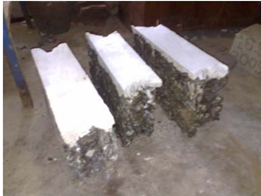
Gambar. 2.1 Bata beton non-pasir sebelum di uji.
